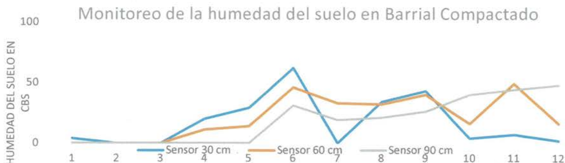
Fig. 4. Tensión de humedad del suelo en barrial compactado medida en centibares (cb) a tres profundidades del suelo (30, 60 y 90 cm) en huerta de nogal ubicada en el block 1008 del Valle del Yaqui.
